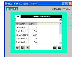
Der Prüfstand wird über ein OP bedient.
